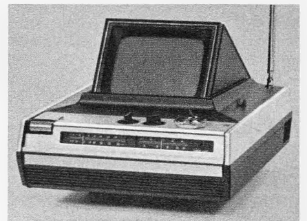
Bild 3. Kombination eines AM/FM-Rundfunkgerätes mit einem Schwarzweiß-Fernsehempfänger, dessen Bildschirm versenkbar ist (Modell TR-425 EU)
